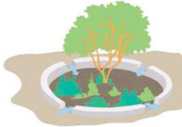
Şekil 5.6. Süzdürme çanakları uygulama örneği 46
