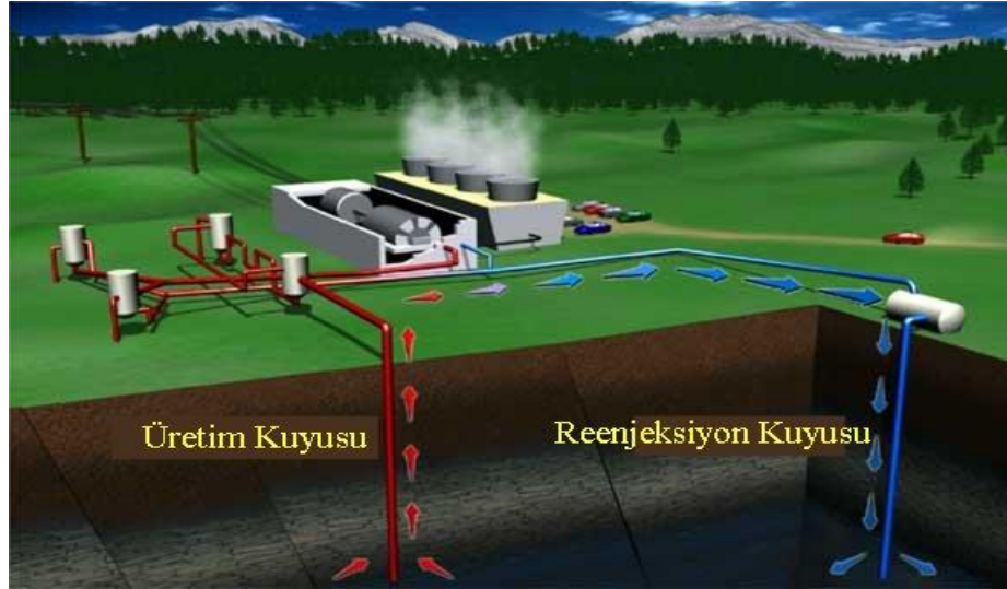
Şekil 2.3: Jeotermal enerjinin elektrik üretiminde değerlendirilmesi
