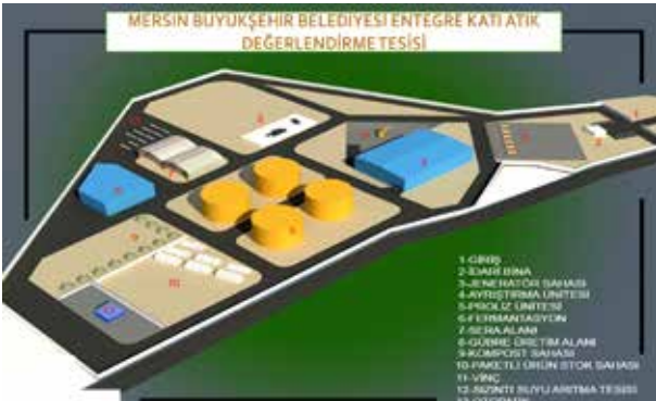
Şekil 4. Entegre Atık Yönetim Prosesi Yerleşim Planı
